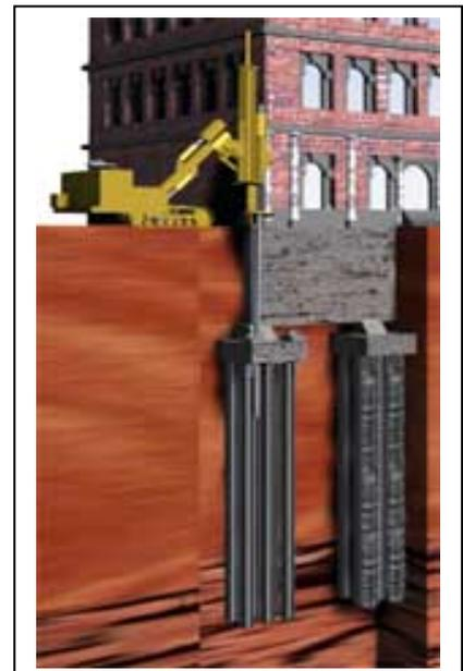
El uso de la perforación y la introducción de la lechada para construir el micropilote reduce tanto las vibraciones como cualquier efecto que pueda producirse en la estructura en comparación con otras técnicas de instalaciones de pilotes.
